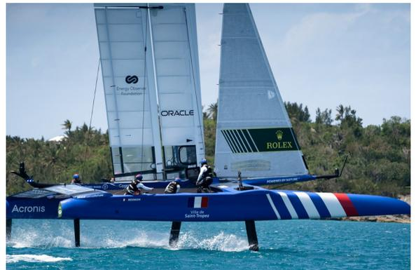
Mais qu'est-ce que c'est un foil ? Eh bien, cela ressemble à des ailes/ailerons en forme de L ! positionnés sur les côtés, immergés ou non, les mouvements d'eau autour de ceux-ci créent une force qui va alors « porter » le bateau (comme les ailes d'un avion) et littéralement le faire voler, lui conférant ainsi légèreté et beaucoup, beaucoup plus de vitesse (jusqu'à 90km/h) ! Avec l'avènement du foil, c'est véritablement une nouvelle ère qui s'annonce pour la voile sportive !
